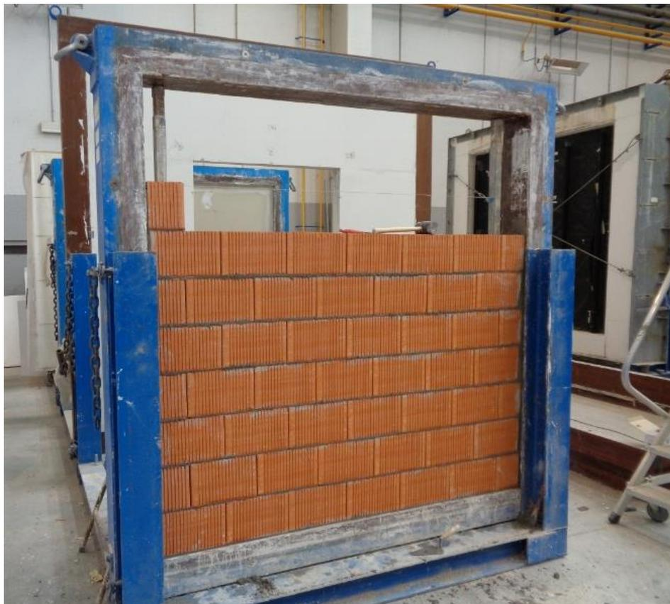
**Figura 3.** Levante de la fábrica de 2 m x 2m. La muestra produjo un total de 10 hileras de aprox. 6,5 piezas cada una
