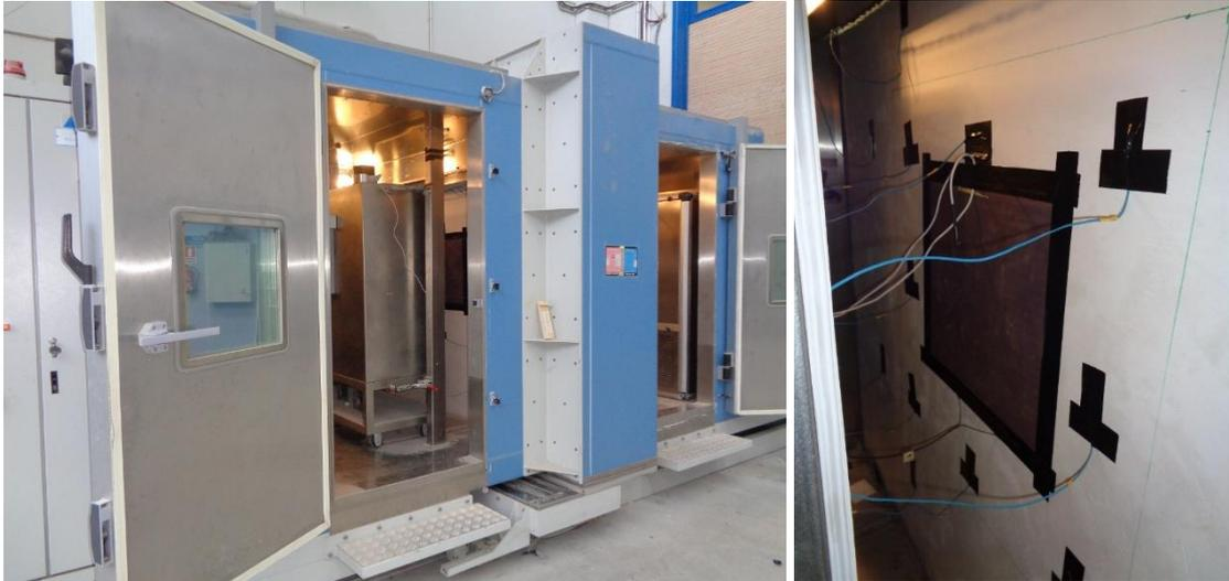
**Figura 12.** Aspecto de la cámara caliente del equipo de ensayo y del medidor de flujo de calor en la cara caliente de la muestra.
