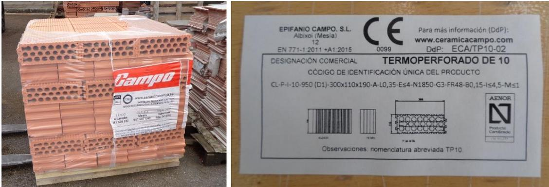
**Figura 2.** Aspecto y etiqueta de las piezas cerámicas recibidas en el laboratorio para la fabricación de la muestra.
