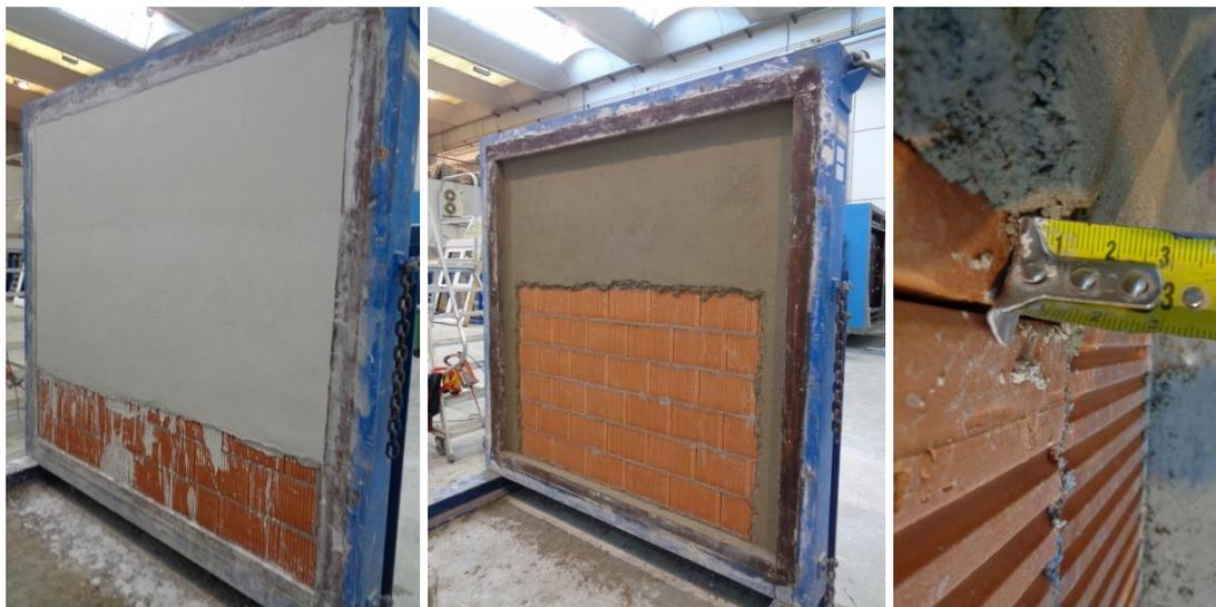
**Figura 6.** Revestimiento con yeso en cara caliente (izq.), con mortero de cemento en cara fría (cen.) y detalle del espesor de mortero de 1,5 cm (der.).
