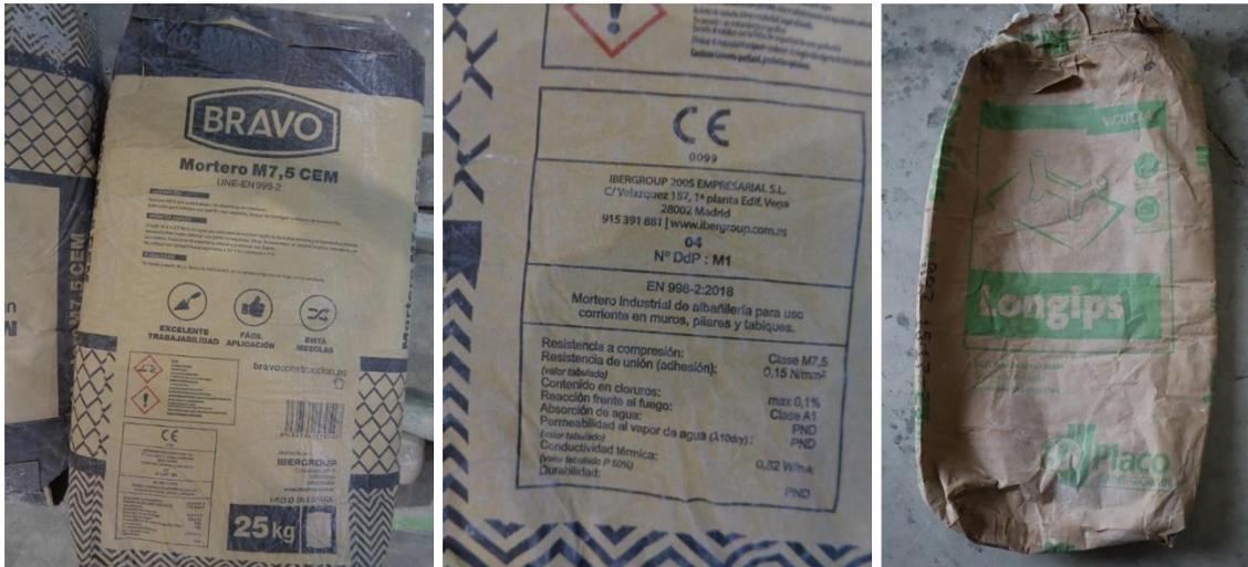
**Figura 7.** Referencias comerciales de los materiales de los revestimientos: mortero M7,5 marca Bravo y yeso Longips de Placo Saint-Gobain. El mortero de cemento también se ha usado para el tendel.
