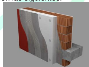
Fachada con un aislamiento térmico por el exterior (SATE o prefabricado con plaqueta cerámica vista)
