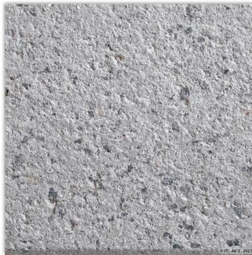
Figura 1 Imagen de la muestra 1: **Baldosa hidráulica, Color Gris Santiago, Acabado Granallado**
